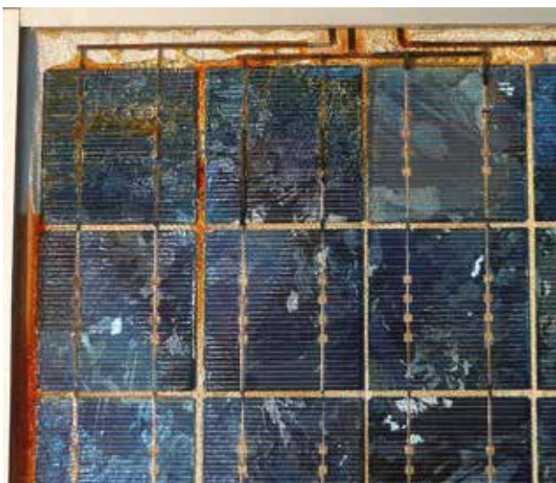
Exemple de signature visuelle : la corrosion (Crédit photo : Hespul)
