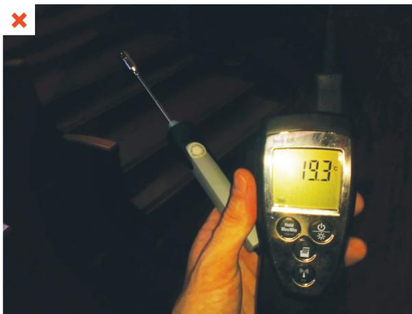
Le défaut de maintenance de la GTB ne permet plus de régler les plages de fonctionnement et la température de consigne de la climatisation. Cette dernière fonctionne en dehors de la période d'usage prévue (ici le week-end) et à une température très basse (19,3°C). ©AQC
