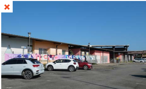
Les véhicules stationnent à proximité des façades. Les rayonnements lumineux se reflètent sur les pare-brise des véhicules et sont renvoyés vers les fenêtres des locaux. ©AQC
