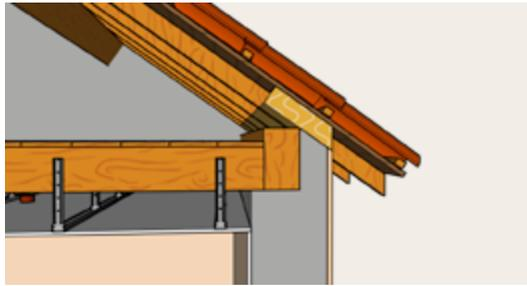
**1.3** Pose d'isolant en tête de mur entre chevrons
