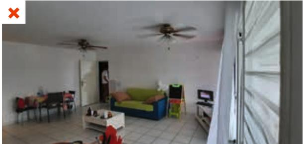
✗ Espace prévu en ventilation naturelle ne disposant que d'ouvertures en façade. Le flux d'air n'est pas suffisant pour procurer une sensation de confort. Ce phénomène est d'autant plus important lorsque la porte est fermée. ©AQC
