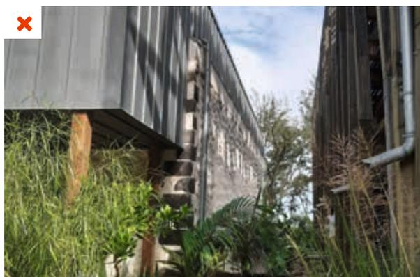
La proximité entre ces ouvrages nuit à la qualité des flux d'air. Le bâtiment de gauche limite la vitesse du vent pour le bâtiment de droite. ©AQC
