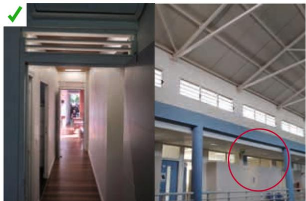
✓ Mise en œuvre d'impostes au-dessus des portes intérieures, voire des cloisons de circulation contribuant au passage du flux d'air. ©AQC
