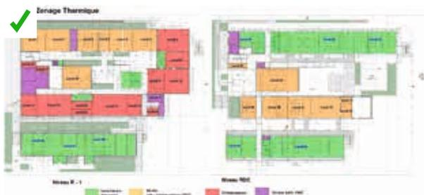
Cet exemple de plan de zonage thermique présente à gauche le niveau R-1 et à droite le RDC. Les espaces en ventilation naturelle apparaissent en vert, les espaces fonctionnant en mixte (naturelle + climatisation) en orange et les espaces climatisés en rouge. Au R-1, sont situés les espaces climatisés destinés aux laboratoires où du matériel sensible est utilisé. Les zones climatisées ou mixtes sont placées en continuité. ©AQC
