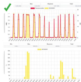
Les consommations électriques liées à l'appoint (graphique du haut) et le suivi du puisage d'eau chaude (graphique du bas) permettent le suivi, l'analyse et la détection des éventuelles dérives. La part couverte par les panneaux solaires peut être déduite. ©AQCC
