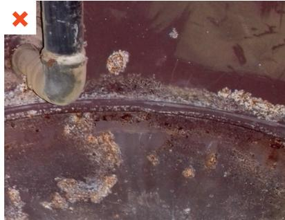
Corrosion interne des ballons de stockage en l'absence de mesures de protection. ©AQC
