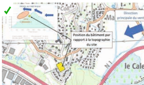
Plan de localisation permettant d'appréhender le positionnement de l'ouvrage dans le relief et son orientation aux vents. ©Watt Smart
