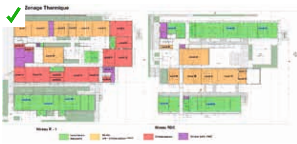
Cet exemple de plan de zonage thermique présente à gauche le niveau R-1 et à droite le RDC. Les espaces en ventilation naturelle apparaissent en vert, les espaces fonctionnant en mixte (naturelle + climatisation) en orange et les espaces climatisés en rouge. Au R-1, sont situés les espaces climatisés destinés aux laboratoires où du matériel sensible est utilisé. Les zones climatisées ou mixtes sont placées en continuité. ©AQC
