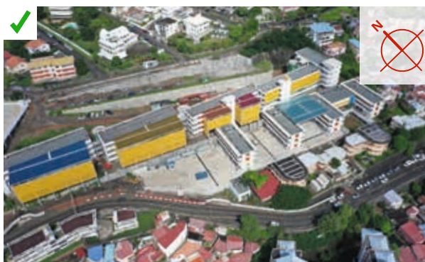
L'origine des vents et de la pression acoustique ont été prises en compte pour l'implantation des bâtiments en fonction de leur destination. Les bâtiments accueillant les activités les plus calmes (bibliothèque, salle de classe, etc.) sont placés en amont de la direction principale du vent (au vent) et les bâtiments les plus bruyants (gymnase, espace de restauration) sont situés en aval (sous le vent). ©AQC
