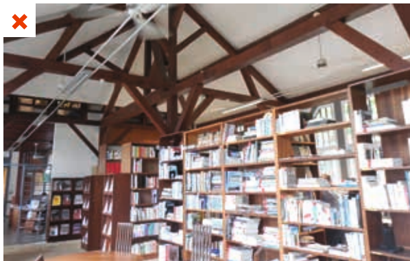
Espaces dédiés aux archives dans un bâtiment proche de la mer totalement en ventilation naturelle. La poussière et l'humidité dégradent les documents. ©AQC
