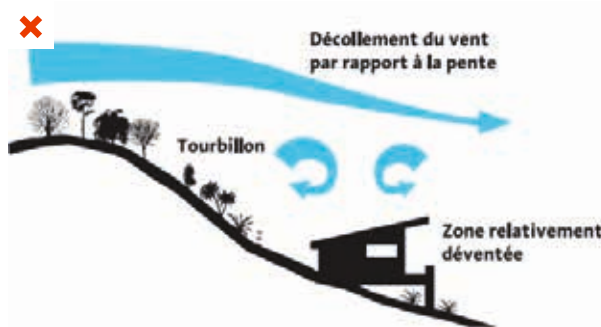
Site sous le vent des collines ou de dénivelés. L'effet de décollage provoque des vents contraires et crée une zone déventée défavorable à la ventilation naturelle. ©Guide Ecodom
