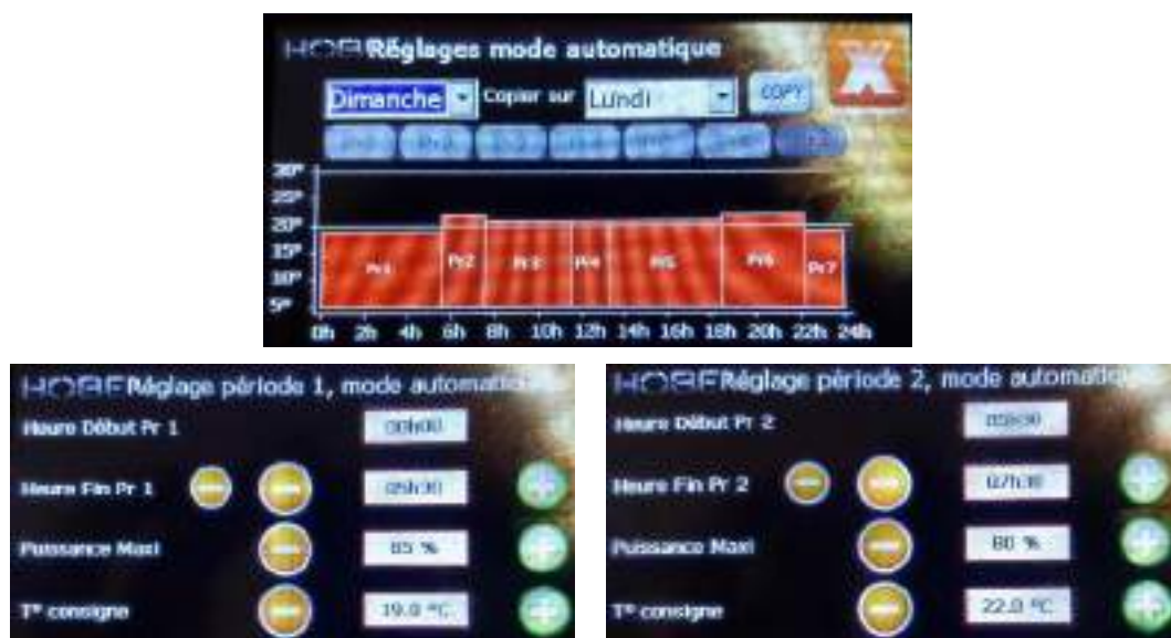
Figure 112 : Illustration : Exemple de programmation horaire d'un poêle à granulés.
