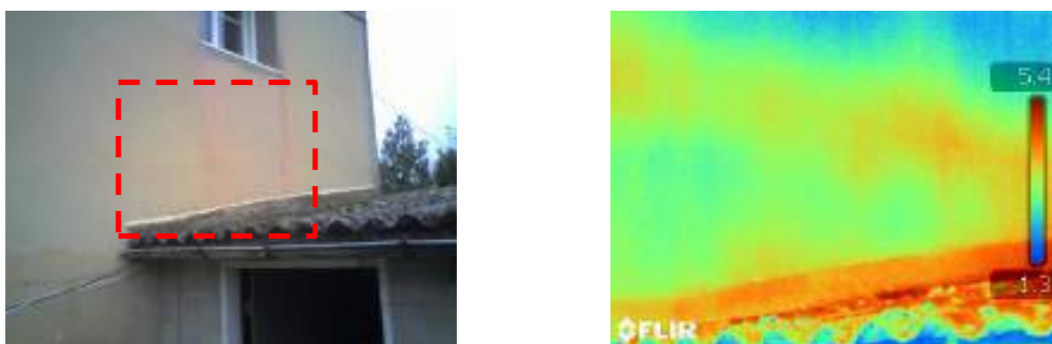
Figure 78 : Thermogramme de mur isolé par l'intérieur, au niveau du plancher intermédiaire béton.
