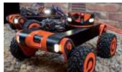
Figure 162 ci-contre : Illustration d'un robot permettant projeter du polyuréthane en sous-face d'un vide sanitaire de faible hauteur. Source : www.syneris-isolation.fr
