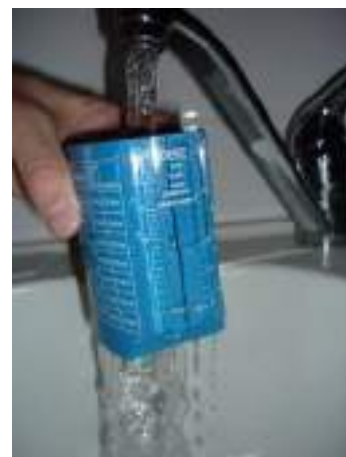
Figure 168 ci-contre : Illustration de la mesure de débit aux points de puisage ECS avec un débitmètre (source Enertech, image d'archive).
