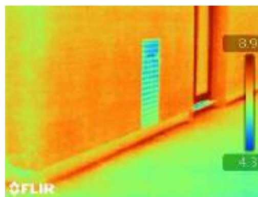
Figure 82 : Thermogramme de la liaison du mur avec le sol en présence d'une ITE non enterrée.
