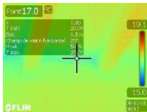
Figure 80 : Thermogramme intérieur de mur isolé par l'intérieur, au niveau du plancher intermédiaire bois.
