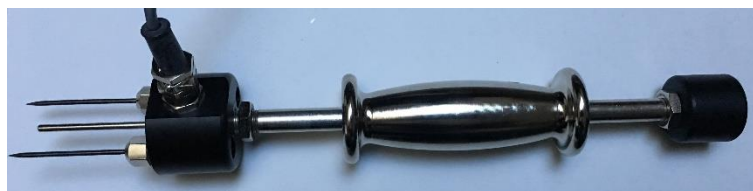
Figure 10 - Exemple d'humidimètre à pointe
