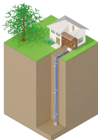
Sondes géothermiques verticales - © ADEME-BRGM
