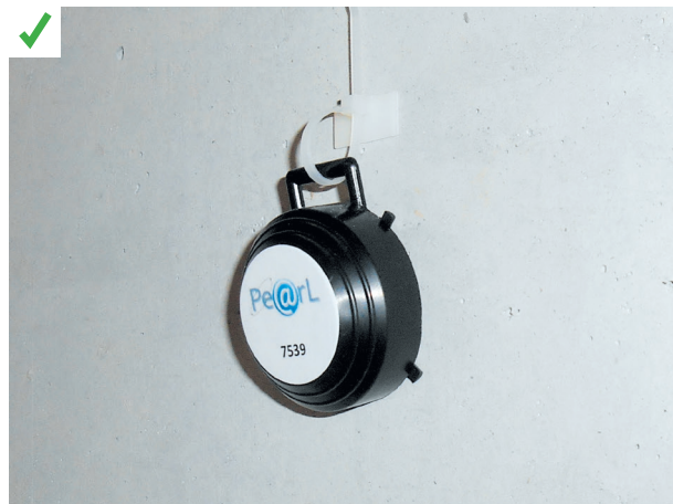
La concentration en radon peut être mesurée à l'aide d'un dosimètre dans chacune des pièces du bâtiment. ©AQC
