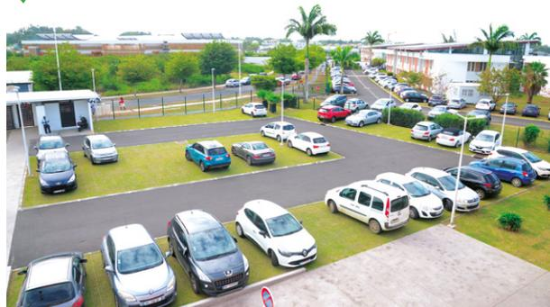
Places de stationnement engazonnées permettant de réduire la bulle urbaine de chaleur. Bâtiment tertiaire. ©AQC
