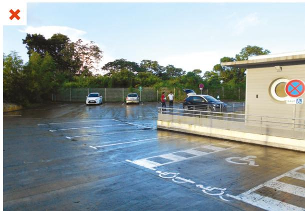
Aménagement extérieur très minéralisé engendrant une accumulation de chaleur aux abords du bâtiment. Bâtiment tertiaire. ©AQC
