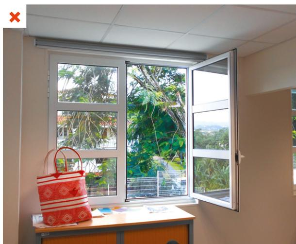
En l'absence de dispositif d'entrée d'air neuf, les occupants sont obligés d'ouvrir la fenêtre de leur bureau régulièrement pour renouveler l'air intérieur. Bâtiment tertiaire. ©AQC
