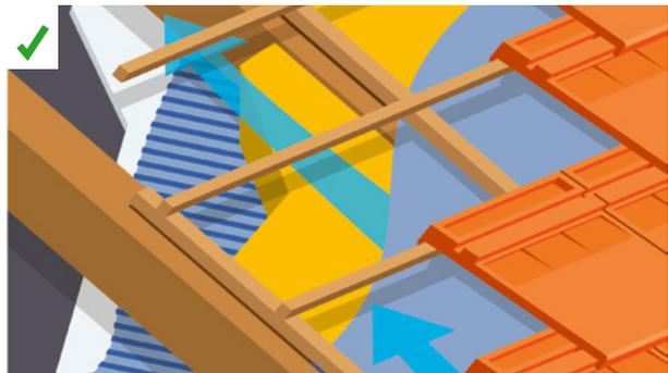
Lorsqu'un écran de sous-toiture non ouvert à la vapeur d'eau est présent, une lame d'air ventilée de 2 cm minimum doit être conservée entre la couverture et l'écran de sous-toiture d'une part et entre l'écran de sous-toiture et l'isolant d'autre part. ©AQC
