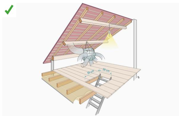
Le schéma ci-dessus illustre les bonnes pratiques pour un accès facile, éclairé et sécurisé au caisson de ventilation.
